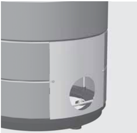
Abb. 3.16 Revisionsblech an der Geräterückseite mit Ausschnitt für die Leitung
