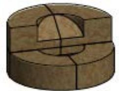
. . . dann wird die zweite Schicht mit zwei Segment-Speichersteinen komplettiert.
