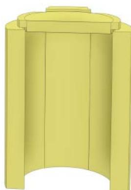
Die Bodensteine werden zwischen die Seitenwände auf das Bodenblech des Feuerraums gelegt. und der Ascherost in den Feuerraum hineingelegt.
