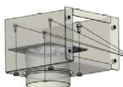
La lamiera del cassetto di alimentazione e il relativo bocchettone ad essa avvitato vengono nuovamente montati alla base del cassetto con 4 viti.
