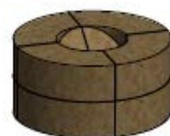
In der zweiten Schicht werden die abgeschrägten Steine „umgekehrt“ auf die abgeschrägten Steine der ersten Schicht gelegt . . .
