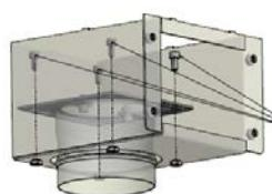
Das Blech des Zuluftkastens wird nun mit dem daran angeschraubten Zuluftstutzen wieder am Boden des Zuluftkastens mit 4 Schrauben montiert
