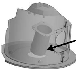
Le Faro doit alors être posé à plat pour permettre le dévissage (4 vis à tête cylindrique de 4 mm) du couvercle de l'orifice d'arrivée d'air dans le fond. On y introduit ensuite l'embout d'arrivée d'air.
