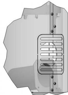
Ces languettes de retenue doivent être sectionnées et la tôle déposée pour permettre le montage par l'arrière d'un canal d'arrivée d'air sur l'embout.
